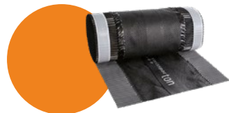
Páska na hrebeň RBF vent z vysokokvalitného hliníka, perforovanej polypropylénovej netkanej textilie a silného butylového lepidla. (červená U03 / čierna U06 / sivá U07 / hnedá U11) 0,31 x 5 m 20,40 EUR* UNI 3798 1 rolka
